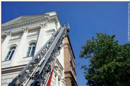
Abb. 5: Mit geringem Aufwand stellte die Feuerwehr durch einen Anleiterversuch die Nutzbarkeit des zweiten Rettungsweges aus den Büroräumen sicher.
